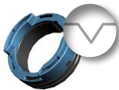
z.B. Ø 1 mm mit V-Nut (Blau): für Stahl, Edelstahl, Fülldraht, Löten
