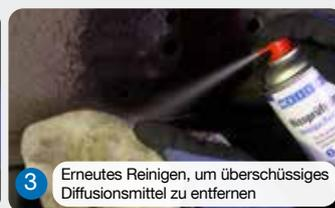
3 Erneutes Reinigen, um überschüssiges Diffusionsmittel zu entfernen
